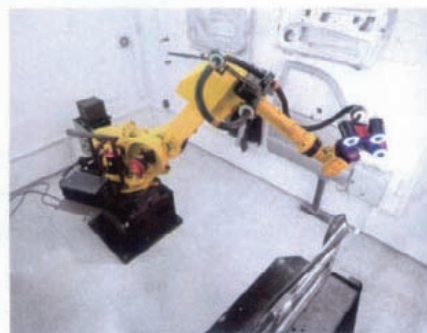
图4 整合了机器人的自动化白光测量系统
